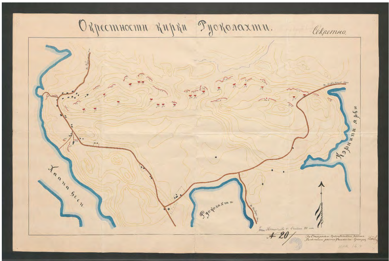
Kuva.. Topografinen sotilaskartta Ruokolahden nykyisen keskustan läpi kulkevasti ensimmäisen maailmansodan aikaisesta linnoitusketjusta. Punaiset poikkiviivat ovat taisteluhautoja ja niiden eteläpuoliset punaiset laatikkomalliset merkinnät todennäköisesti suojahuoneita. Maanmittaushallituksen historiallinen kartta-arkisto (kokoelma). Ih. Sotilaskartat. MHA, lh. 4. [Venäläinen sotilastopografinen karttalehti Ruokolahden ympäristöstä, ven.] (1900–1920). Kansallisarkisto. Viitattu 16.11.2022.
