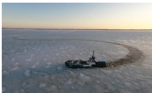
Kuva 11: Irtokeula murtamassa jäätä yhdistettynä hinaajaan Saimaalla. Kuva: Väylävirasto.
