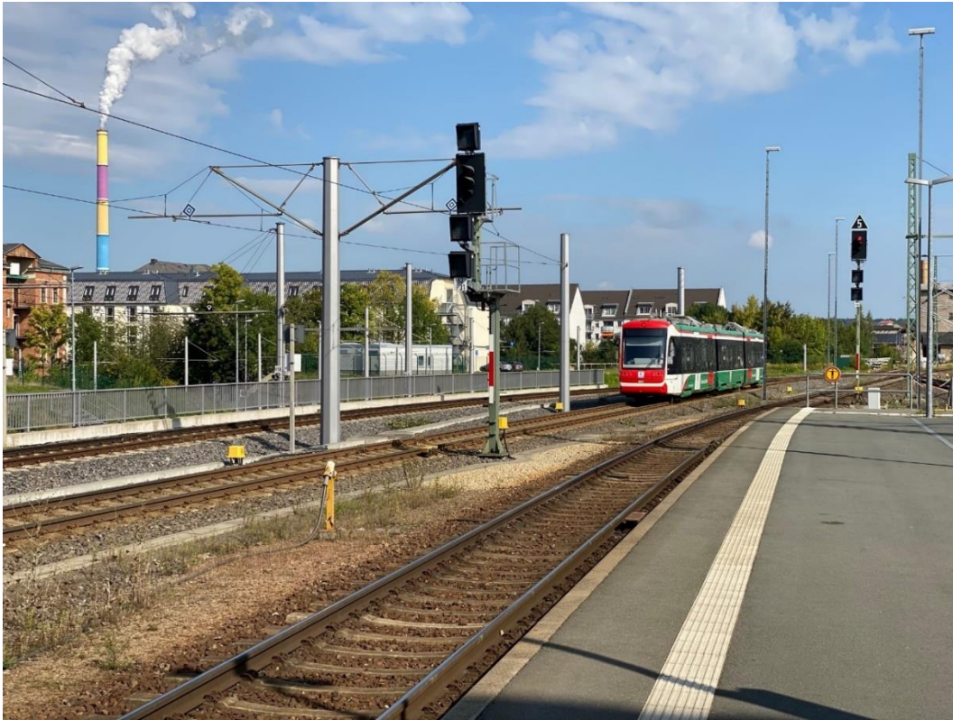
Kuva 3. Esimerkki rataverkolla ja kaupunkiraitiotiellä liikkuvasta kalustosta (duoraitiojunakalustosta) rataverkolla. Kuva: Anssi Krooks.
