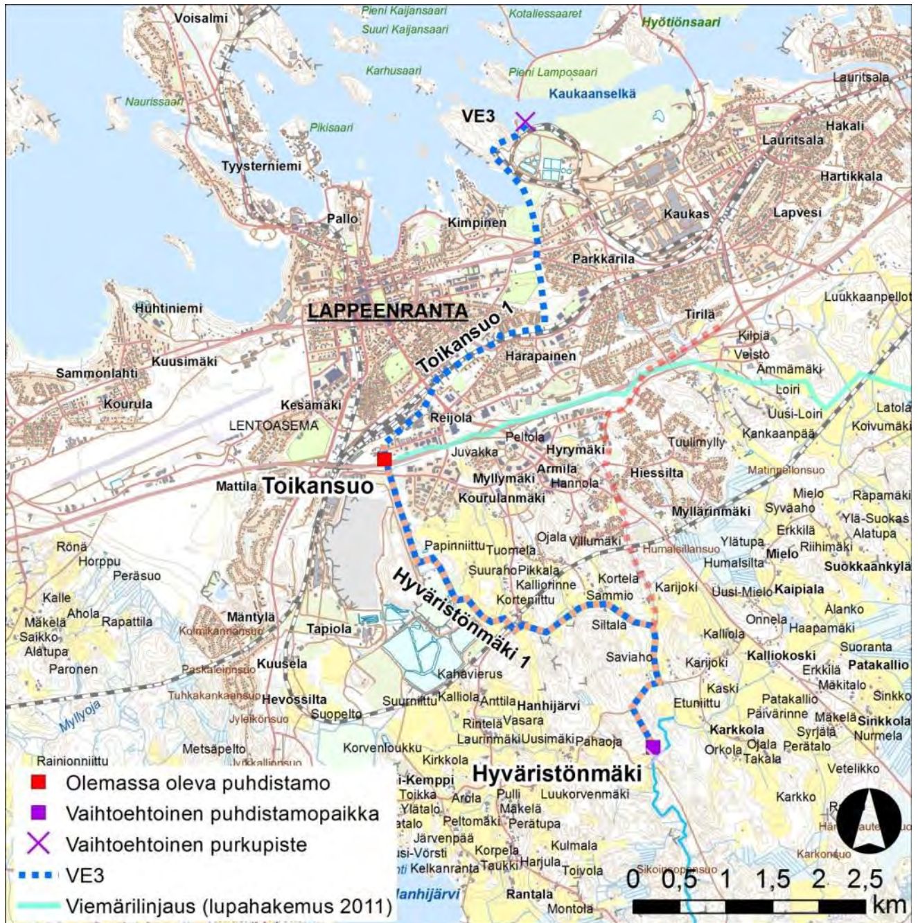
Kuva 3-3. Vaihtoehdossa VE3 puhdistamo sijoitetaan Toikansuolle tai Hyväristönmäelle, joista puhdistetut jätevedet johdetaan siirtolinjaa pitkin Kaukaanselälle.
